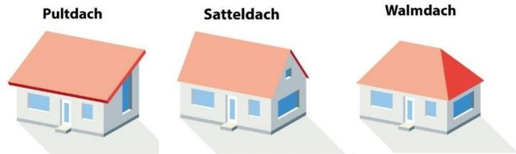
Bei einem **Pultdach** kann die gesamte Dachfläche für eine PV-Anlage genutzt werden. Bei einem **Satteldach**
